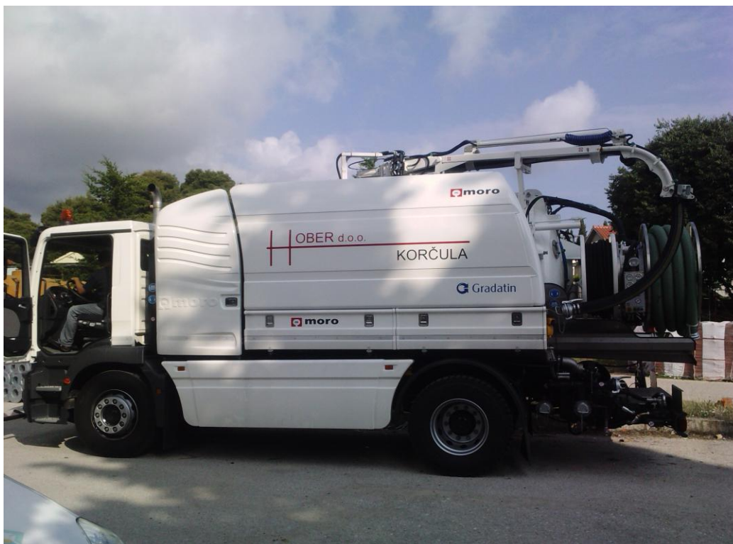
Novo vozilo za održavanje kanalizacije – kanal jet
