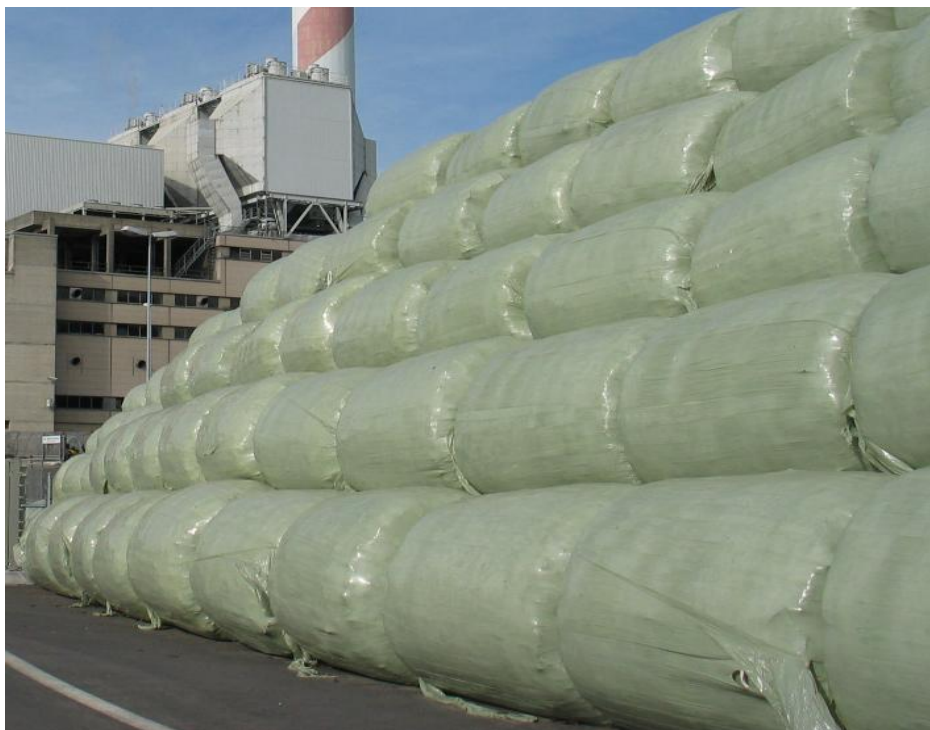
skladište baliranog otpada
