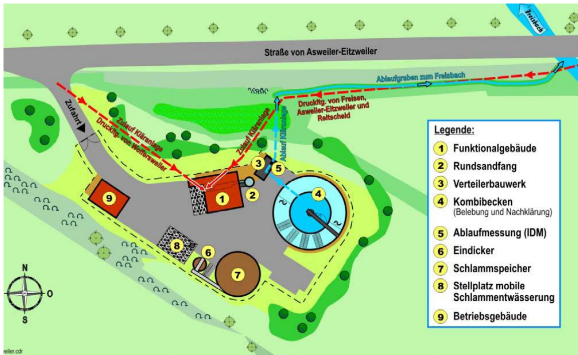
shematski prikaz bio-pročistača sa najvažnijim djelovima za 5.500 ES
