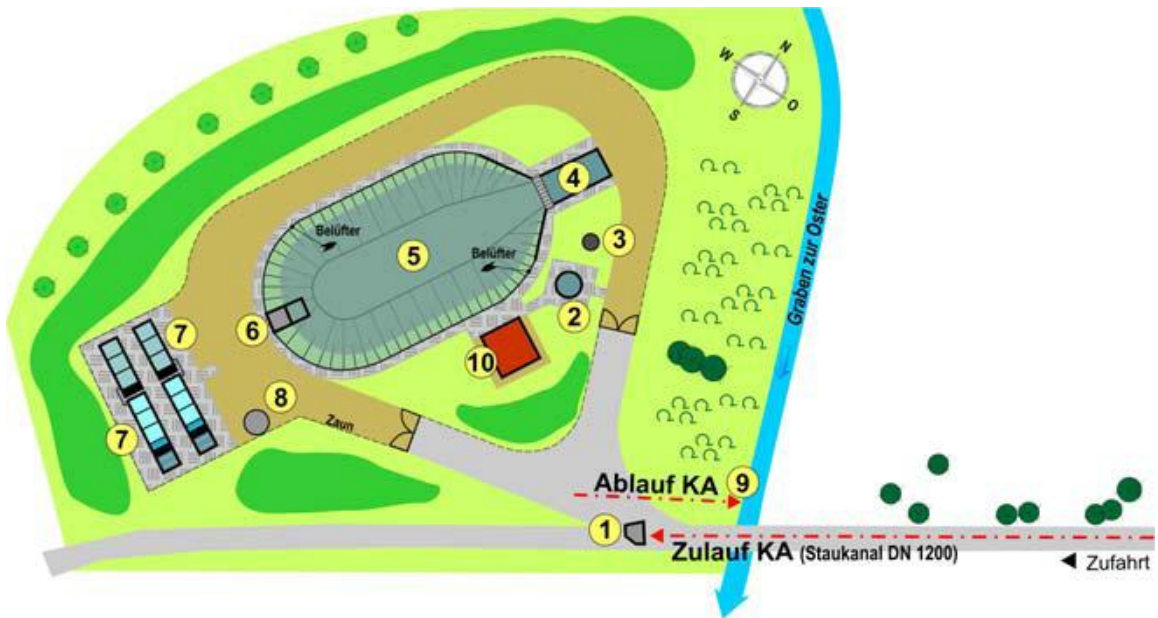
shematski prikaz gornjeg bio-pročistača za 600 ES
